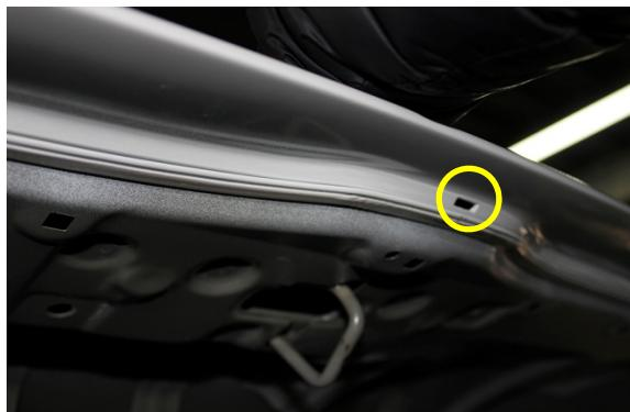
専用ステーでポンネットパネルをポンネットに固定します。(3箇所)
