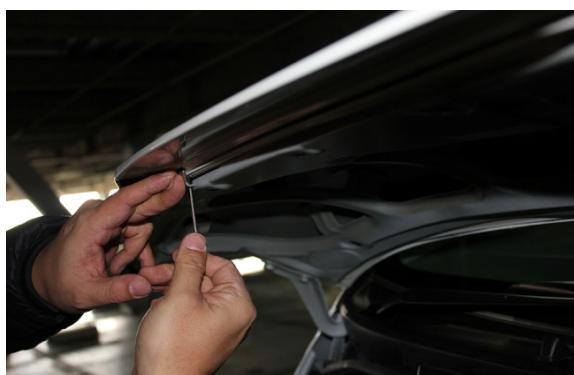
両面テープを剥がしてポンネットパネルをポンネットに貼り付けます。
