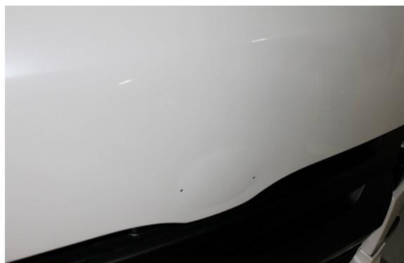
②両面テープを貼り付ける部分(ボンネット、ボンネットパネル共に)の脱脂処理を行います。
